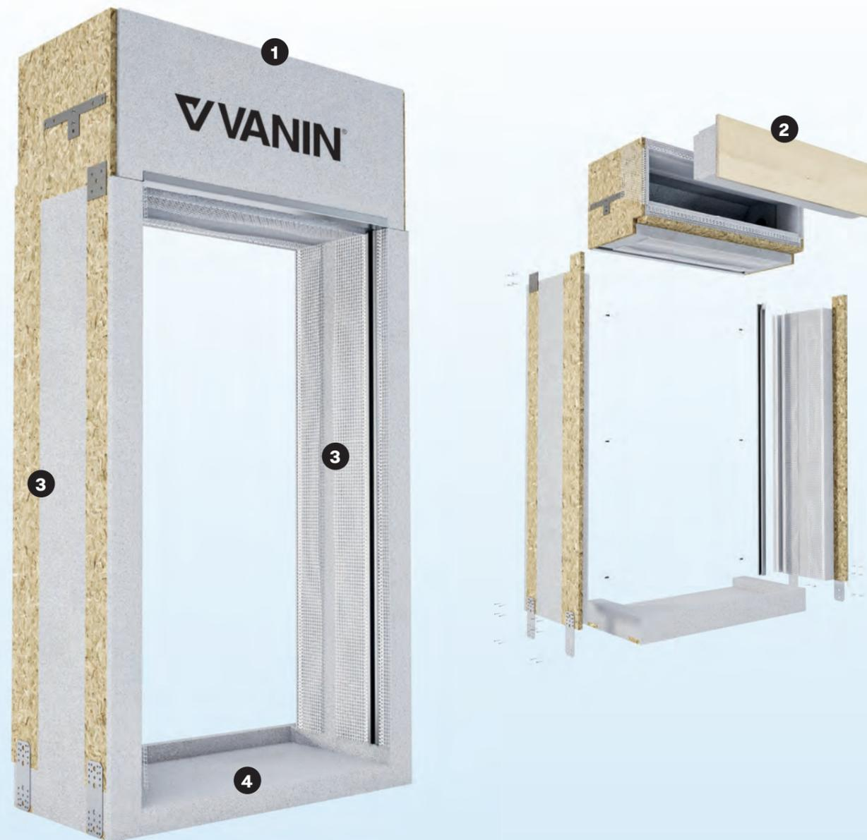
**1** Cassonetto in EPS ad ispezione interna per avvolgibile ad alta densità. Completo di coperchi laterali autoportanti in OSB con rivestimento in EPS e annessi supporti per rullo avvolgitore, profilo di rinforzo veletta esterna e piastre di raccordo tra spalla e cassonetto. Sede serramento ad incasso ricavata nella traversa superiore e fissaggio predisposto con tavoletta in OSB.
